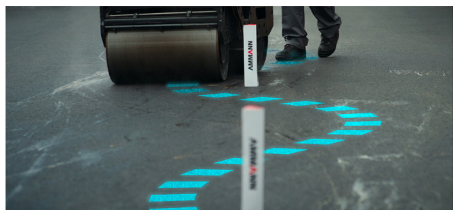
AWR 65-S Rullo a guida manuale con angolo di sterzata di 15°
